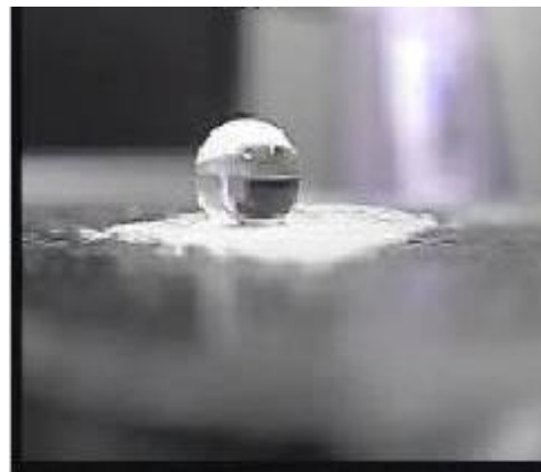
Uma gota de água sobre um tecido de algodão depois do tratamento com plasma.
