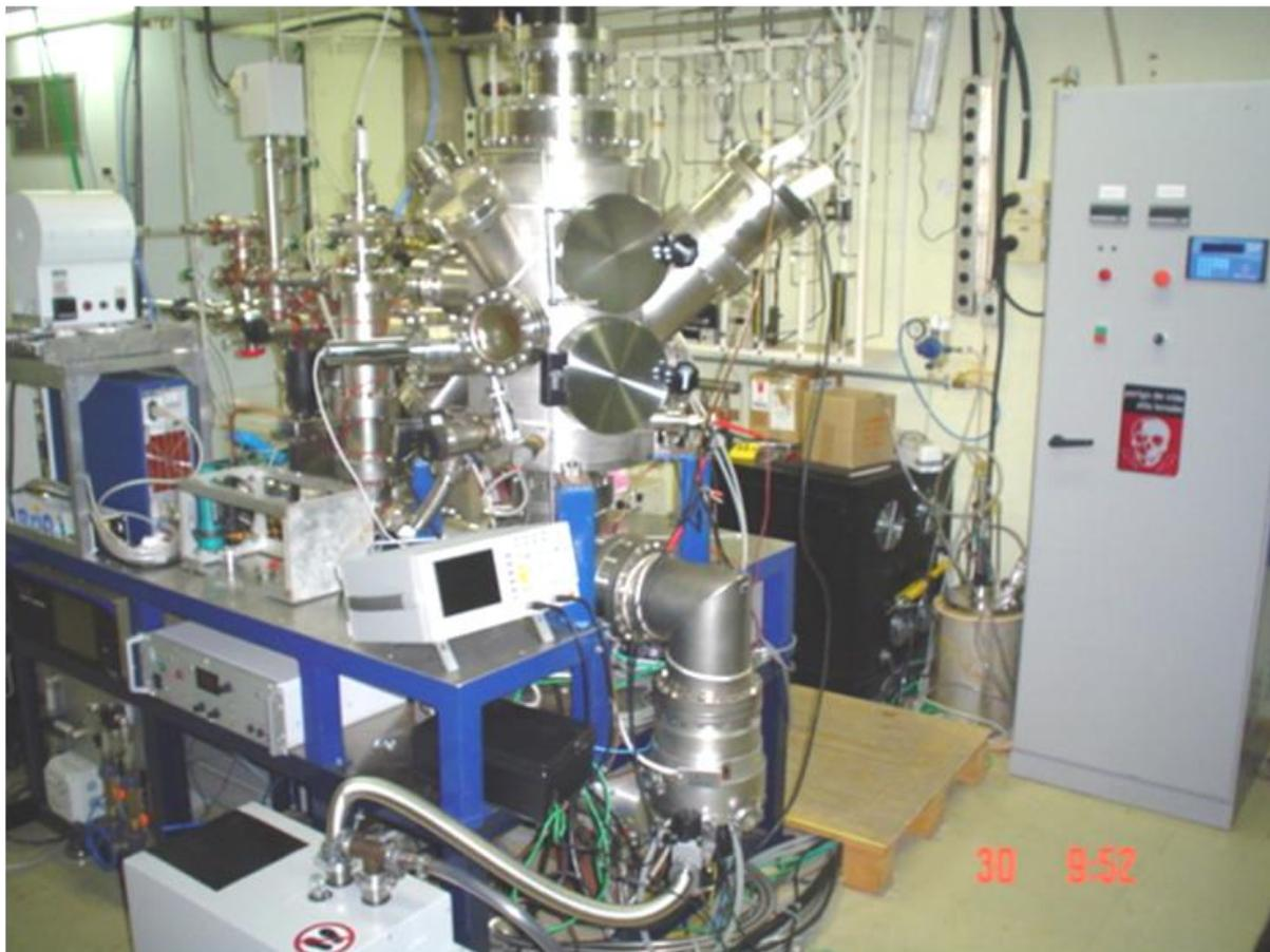
Figura 1. Sistema de deposição a arco catódico filtrado em vácuo projetado e construído no IFGW-Unicamp.
