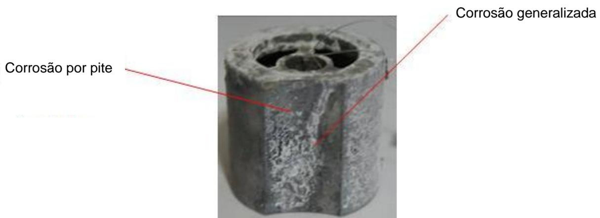
Figura 1. Corrosão: fotografia de peça de Zamac 5 submetida a ensaio de névoa salina.
