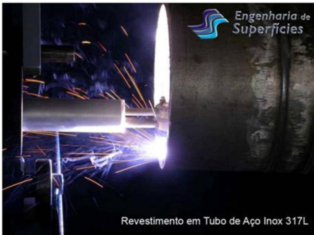
Figura 2. Processamento por PTA da superfície interna de tubulações com diâmetro interno de 25cm.
