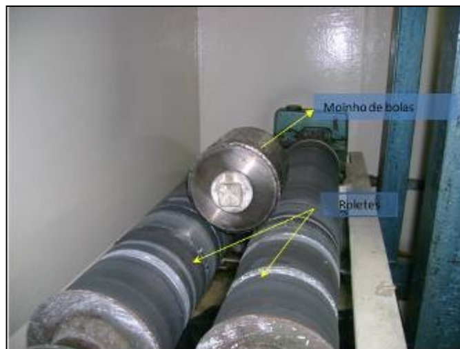
Figura 18 - Moinho de bolas utilizado para moagem
