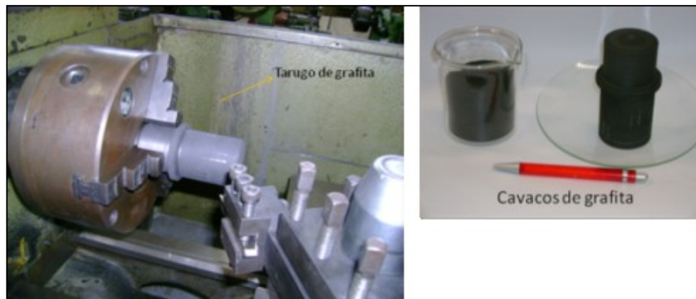
Figura 17 - Geração dos cavacos de grafita por meio de usinagem em torno convencional, no detalhe o pó obtido.
