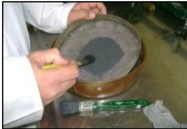
Figura 19 - Desagregação do material após secagem, esta etapa é utilizada como uma primeira classificação.
