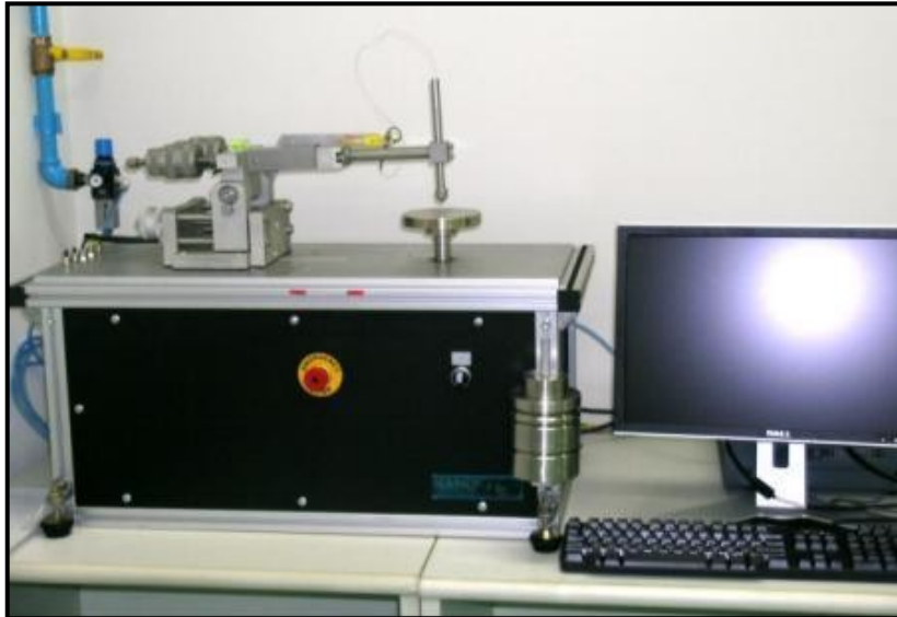
Figura 28 - Tribômetro utilizado no ensaio de atrito e desgaste.
