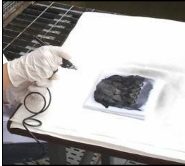
Figura 21 - Recobrimento da superfície do substrato de AISI 52100 através de pulverização.
