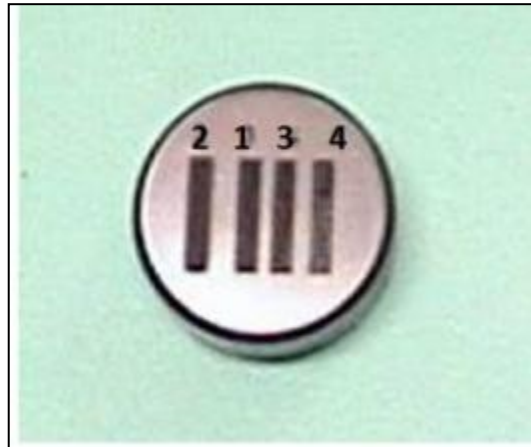
Figura 25 - Trilhas formadas na superfície da amostra que foi irradiada com laser.
