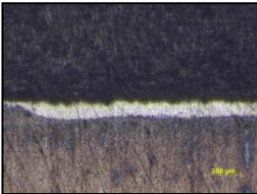
Figura 4B - Secção transversal do aço AISI 52100 processada com 40 mm/s e 10 ciclos de aquecimento
